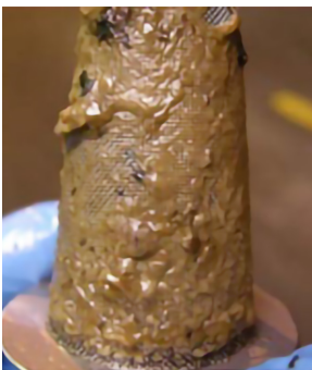
Abb. 1: Biomasse in Dieselmotoren vom Tankboden – schleimartige Masse (Pilze)
