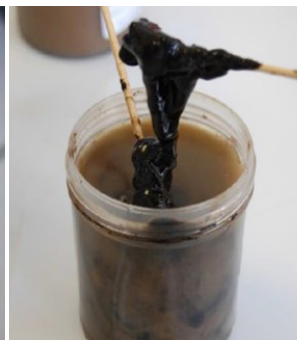
Abb. 2: Biomasseablagerungen an Filter einem Dieselpumpen Filter
